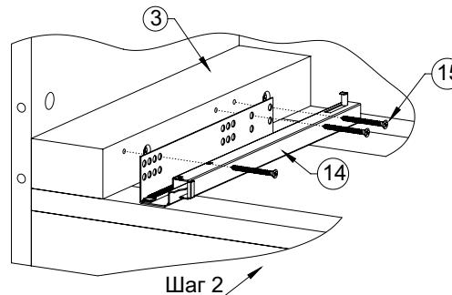
Прикрепить направляющие (16) к поперечине (3) саморезами 3,5x15. При помощи шкантов и эксцентриковой стяжки притянуть столешницу (17) к корпусу (15) как показано на рисунке тумбы, затем саморезами 3,5x15 прикрутить заднюю стенку (18) к корпусу тумбы.
