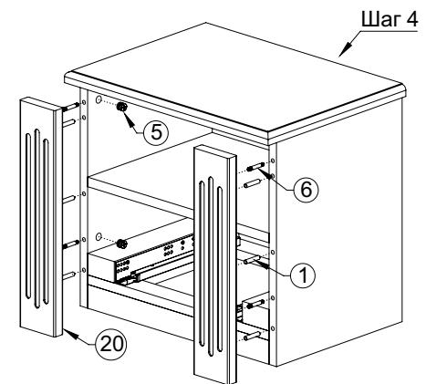
Установить и закрепить фиксаторы (19) при помощи шкантов и сантехническими саморезами 3,5x15 как показано на рисунке. При помощи шкантов и сантехническими саморезами 3,5x15 как показано на рисунке притянуть декоративные планки (20) к корпусу тумбы.
